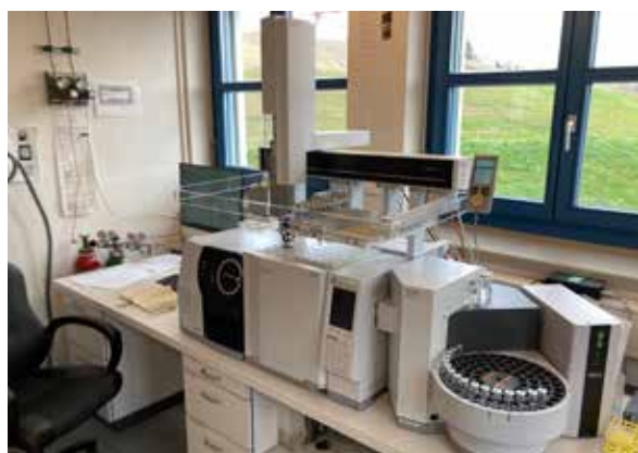
Abb. 3.8: Betriebslabor SMDK: Ansicht Gaschromatograf mit nachgeschaltetem Massenspektrometer
