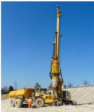
Abb. 5.6: Drehbohrgerät BG 28H
