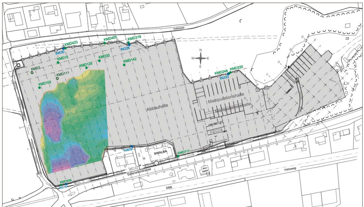
Abb. 4-1: Übersichtsplan: automatische Messstellen (grün Ankerkraftmessdosen; blau Inklinometer) sowie manuelle Ankerkraftmessdosen in der Nordflanke (Kreise) und Inklinometer auf der Westseite der Abbauhalle (rot).
