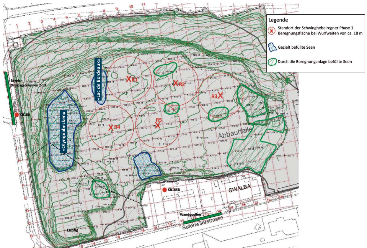
Abb. 4-4: Übersicht über die für die Auswaschung des Untergrundes relevanten Bereiche in der Abbauhalle
