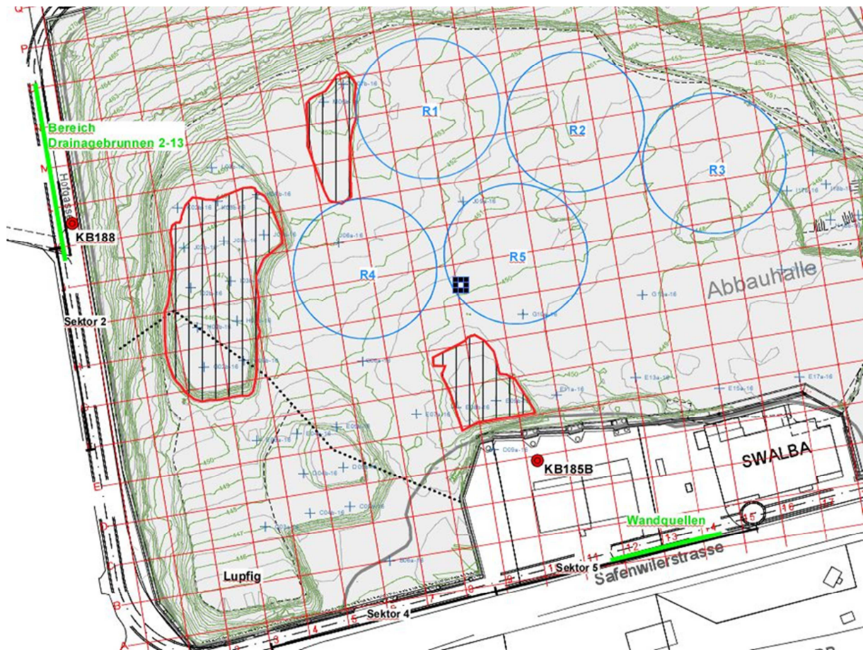
Abb. 6: Übersicht über die für die Auswaschung des Untergrundes relevanten westlichen Bereiche, rot umrandet mit Schraffur die wassergefüllten Becken, blau die betroffenen Bereiche der einzelnen Schwinghebelregner, grün erwähnte Elemente der Abschirmung Süd, Auswahl von Sektoren schwarz
