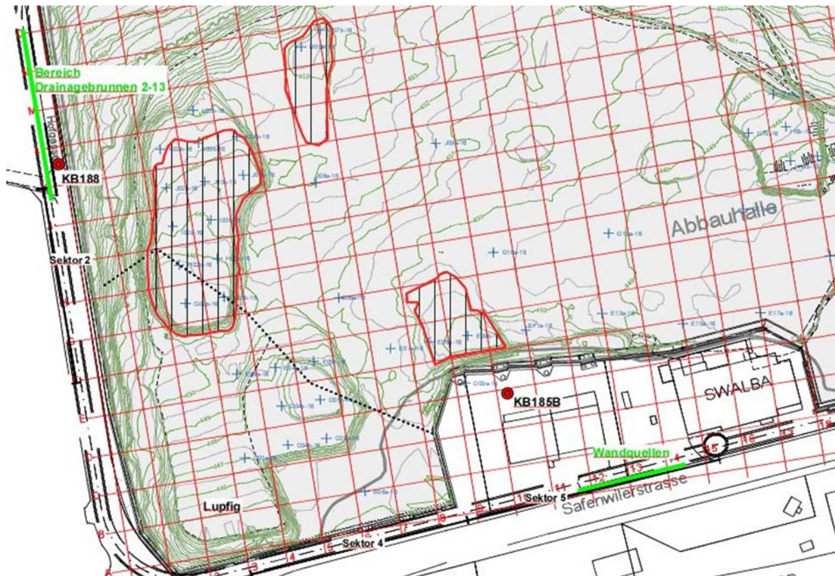
Abb. 9: Übersicht über die für die Auswaschung des Untergrundes relevanten westlichen Bereiche, rot umrandet mit Schraffur die wassergefüllten Becken, grün erwähnte Elemente der Abschirmung Süd, Auswahl Sektoren schwarz
