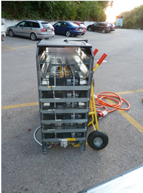
Abb. 6: Beschädigte Batterie der USV (Unterbrechungsfreie Stromversorgung)
