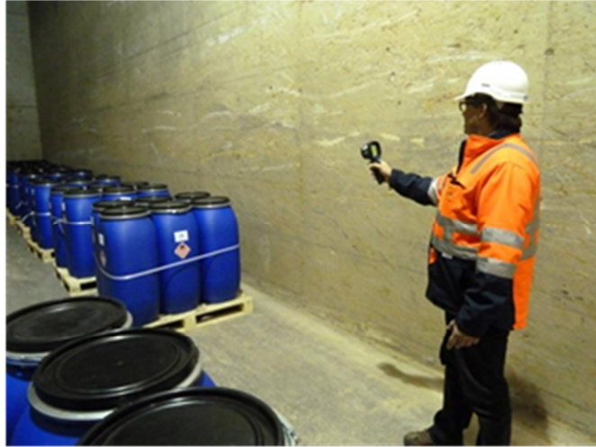
Abb. 8: Nach dem Abfüllen werden die 120 Liter Fässer in der Lagerhalle in einer Lagerbox während mindestens 72 Stunden mit einer tragbaren Wärmebildkamera zweimal täglich (vormittags und nachmittags) kontrolliert.
