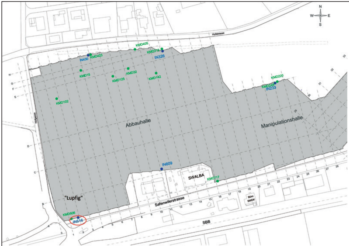
Abb. 4-1: Situationsplan der automatischen Überwachung (KMD: Ankerkraftmessgeräte, IN: Inklinometer), Standort des Inklinometers IN516 rot markiert
