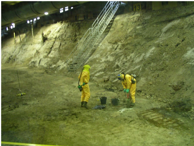
Abb. 8: Blick gegen NW auf die freigelegte Nordböschung. Die Sohle wird durch die Oberfläche einer nur leicht einfallenden Sandsteinbank gebildet. Die Person rechts entnimmt mit einem Handbohrgerät eine Probe.
