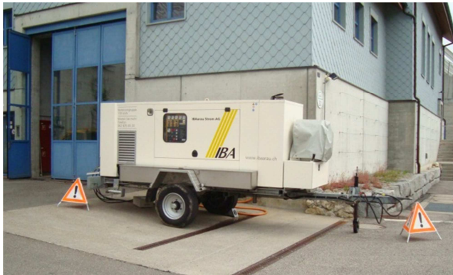
Abb. 14: Stromeinspeisung mittels mobilem Dieselaggregat.
