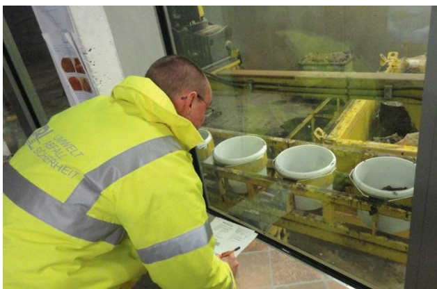
Abb. 6: Begutachtung des Materials durch den Probennehmer durch das Sicherheitsglas der Probenahmekanzlel.
