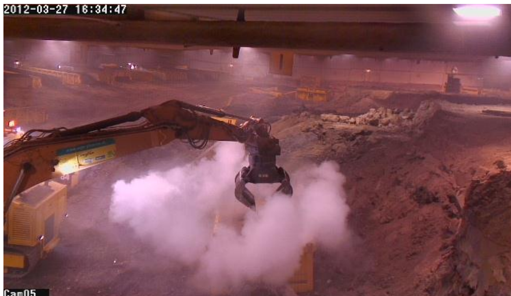
Abb. 8: Bild der automatischen Videoaufnahme: Rauchentwicklung durch entzündeten Phosphor.
