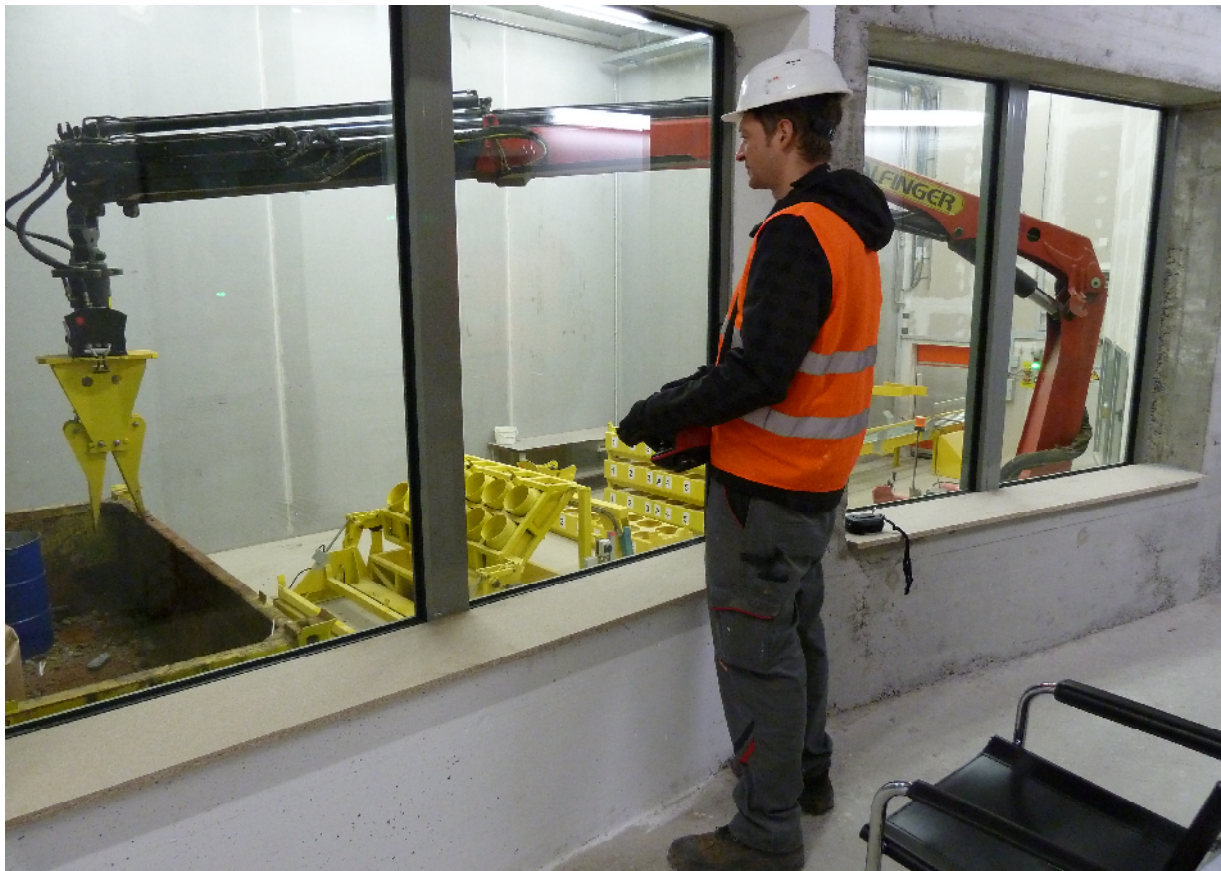
Abbildung: Probenehmer von Los P+A bei der mechanisierten Probenahme mit den neuen, ferngesteuerten Probenahmegeräten.
