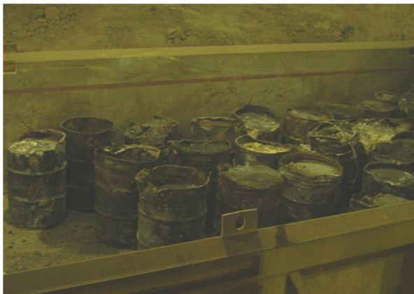
Fässer in Handlingscontainer, bereit zum Transport in den Probenahmebereich
