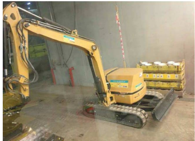
Der ferngesteuerte Probenahmebagger (FPNB) ist eine Spezialentwicklung für die Probenahme im Schwarzbereich.
