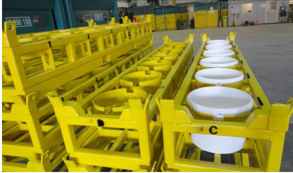
Neue Transportracks mit 6-Eimer Bestückung sorgen für geringere Querkontamination bei der Probenahme.
