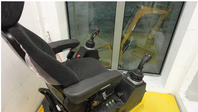
Fernsteuerung des Baggers von der Kanzel im Weissbereich aus.
