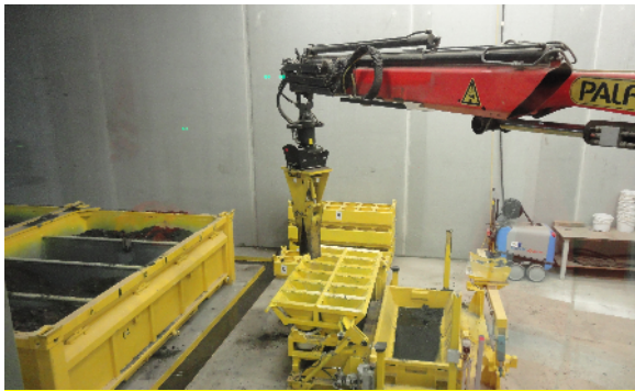
Schüttgutbeprobung aus dem vierkammerigen Beprobungscontainer (links)
