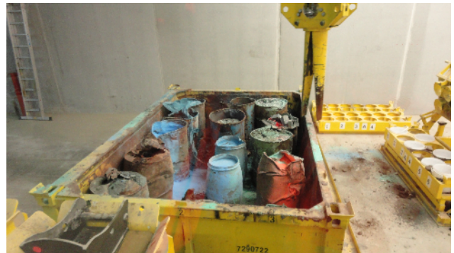
Beprobung von Fässern mit Farbpigmenten und Produktionsrückständen der Chemieindustrie mit dem Kranarm
