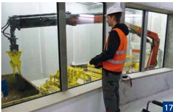
18 Beprobung eines Fassinhalts mit dem Roboter
