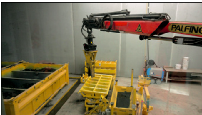
Abb. 5-18: Schüttgutbeprobung mit Probenahmearm aus dem vierkammerigen Beprobungscontainer
