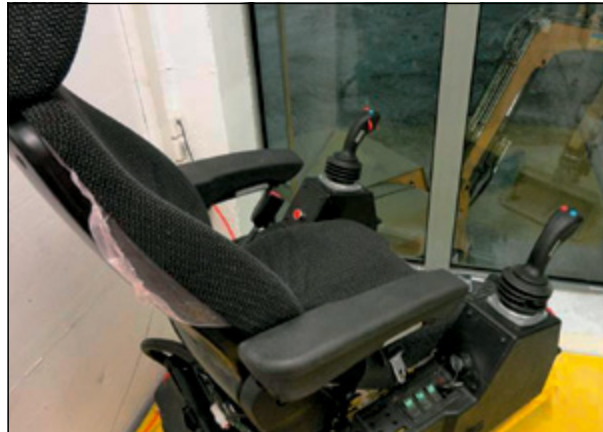
Abb. 5-21: Fernsteuerung des Baggers von der Kanzel im Weissbereich aus
