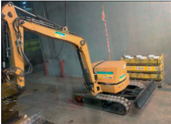
Abb. 5-20: Ferngesteuerter Probenahmebagger (FPNB), eine Spezialentwicklung für die Probenahme im Schwarzbereich
