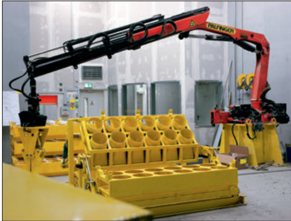
Abb. 5-14: Probenahmekran im Schwarzbereich
