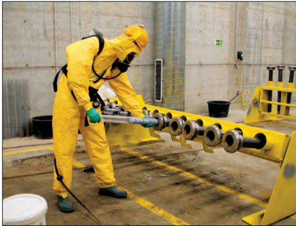
Abb. 5-29: Herausnehmen der gefüllten Inliner
