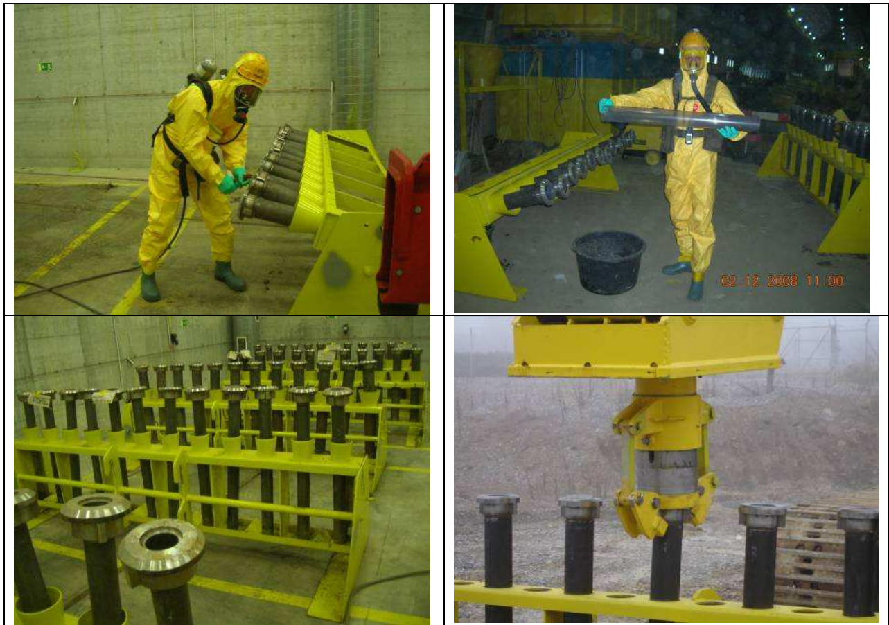
Probenahmerohre für die maschinelle Beprobung der Abbauchargen
