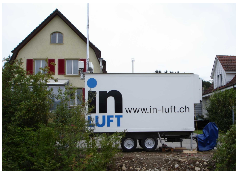
Messstation zur Überwachung der Umgebungsluft an der Hofstrasse nördlich der Deponie
